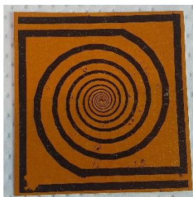
Antena si cip RFID de tip UHF pe substrat de kapton
