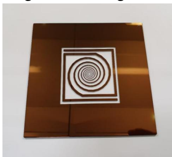
Figura 3. Masca fotolitografica a elementelor de RFID (antenna si retea de atenuare simetrica)
